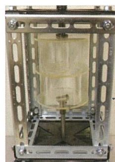
開発した「サボニウス型風車ユニット」
